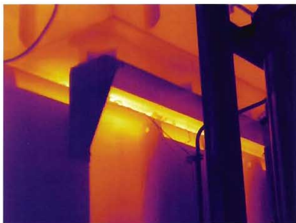
图 J.3 变压器低压侧涡流引起发热
