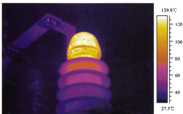
图 J. 22 电缆接头发热，连接不良
