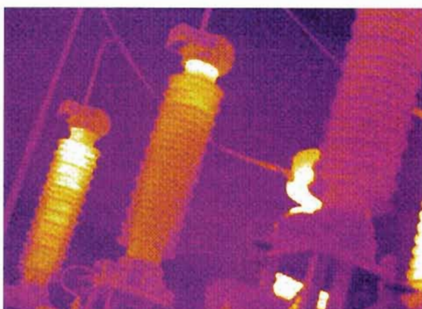
图 J. 19 110kV 氧化锌避雷器发热
